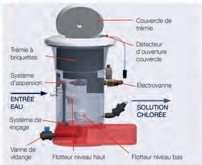
Le système **easiflo®** génère une solution de concentration constante (entre 1,2 et 2% de chlore sous 1 bar de pression d'eau, suivant le modèle), facilitant le maintien d'un niveau de chlore prédéfini dans l'eau.
